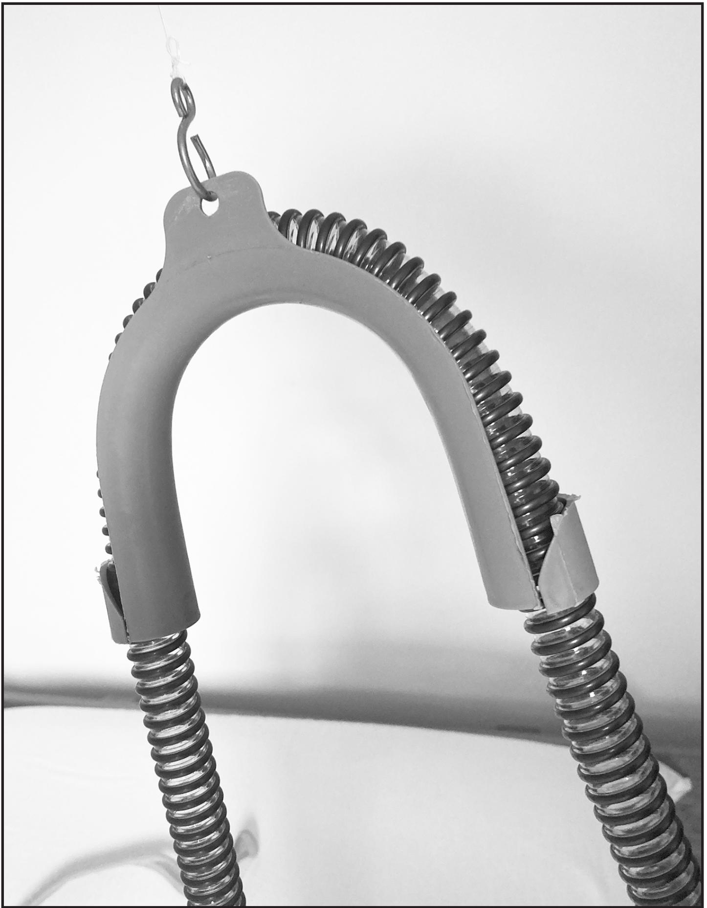
Bitte verwenden Sie ihren eigenen Schlauch! Die Halterung ist für alle handelsüblichen Atemtherapieschläuche geeignet. Ich habe hier noch zusätzlich eine Öse verwendet. Damit lässt sich der Schlauch, zum Transport oder zur Reinigung, einfach aushängen. Bastelschnüre sind von Haus aus elastisch und eine ideale Ergänzung, fast unsichtbar.
